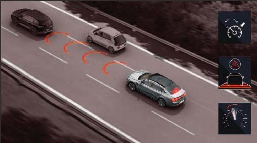
**Regulador de velocidad adaptativo.** Para evitar acercarse demasiado al vehículo que te precede, el regulador de velocidad adaptativo ajusta automáticamente la velocidad con el objetivo de mantener una distancia adecuada.
