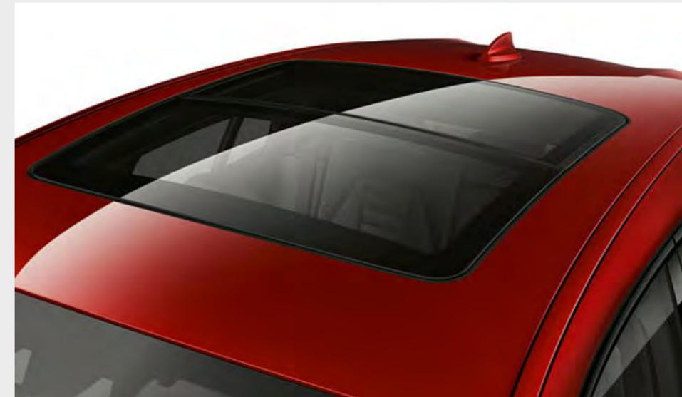
□ El techo de cristal panorámico proporciona aire fresco cuando está abierto y confiere al habitáculo una atmósfera agradable y luminosa si está cerrado. Se abre y se cierra de forma totalmente automática pulsando un botón o con la llave del vehículo, y cuenta con funcionamiento corredizo y abatible, así como persiana solar y deflector de viento
