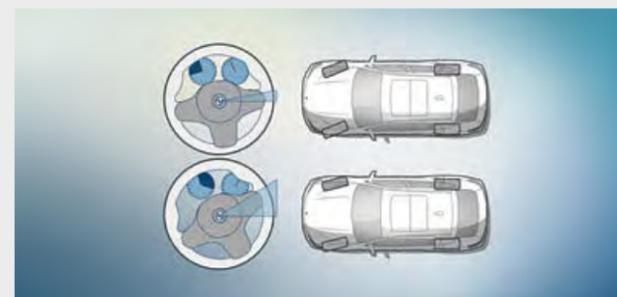
■ La **dirección deportiva variable** con Servotronic facilita una conducción directa y ágil con menos movimientos del volante. Reacciona con diferente desmultiplicación del volante dependiendo del giro. Así se mejora el manejo en la conducción deportiva y se reducen los movimientos del volante al aparcar y girar.
