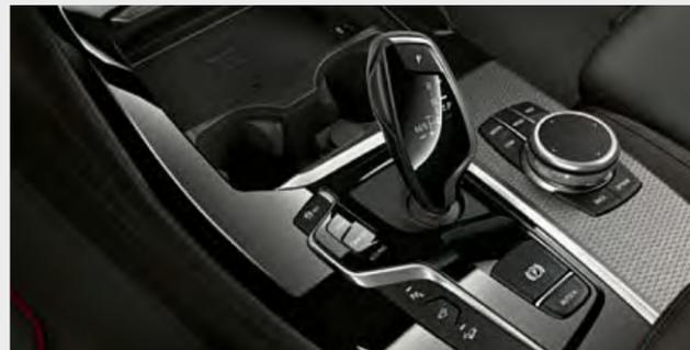
El cambio deportivo Steptronic de 8 velocidades hace posible cambios muy deportivos tanto en modo automático como manual mediante palanca o levas para una conducción especialmente cómoda o dinámica. En el modo SPORT y con la palanca de cambio en el carril de la izquierda en la posición S/M, las relaciones de cambio están orientadas a conseguir las mejores prestaciones posibles.
