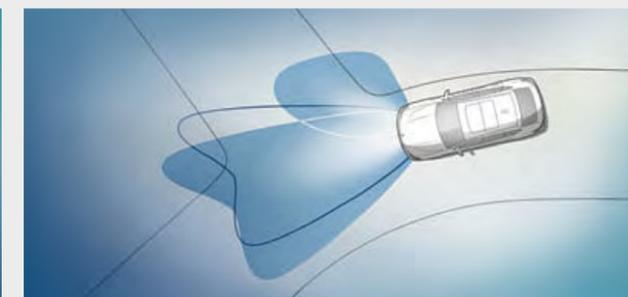
□ Los **faros LED autoadaptables** incluyen función de luces de cruce y de carretera antideslumbramiento (BMW Selective Beam) e intermitentes con tecnología LED integral. Además, el equipamiento de luz lateral ofrece luz diurna y luces autoadaptables con distribución variable de la luz para proporcionar una iluminación óptima de la calzada y una visión óptima en la oscuridad.
