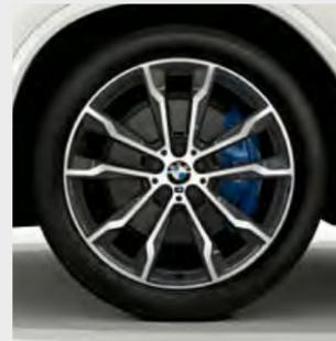
□ Llantas de aleación ligera M de 20 pulgadas con radios dobles estilo 699 M, en bicolor Orbitgrau con pulido brillante, neumáticos de distintas medidas, delante 8 J x 20, neumáticos 245/45 R 20, detrás 9,5 J x 20, neumáticos 275/40 R 20.<sup>1,2</sup>
