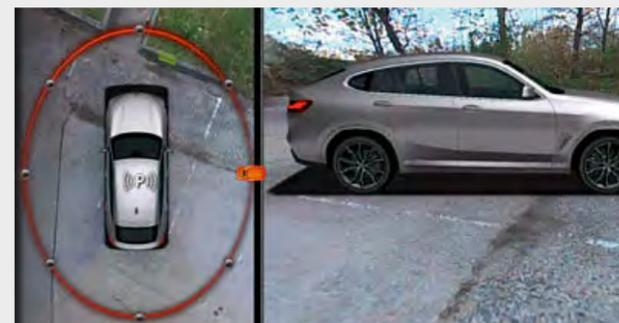
□ Surround View incluye funciones basadas en cámara: Top View, Panorama View, 3D View<sup>6</sup>, Remote 3D View y cámara para marcha atrás. Las cámaras ubicadas en los espejos exteriores y en las partes delantera y trasera del vehículo permiten una vista panorámica de 360°. El sistema Panorama View aporta más seguridad en la aproximación a cruces y salidas de autopistas. Muestra la zona a la derecha y la izquierda del vehículo en el display de control.
