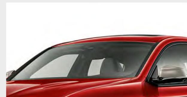
□ El acristalamiento de protección solar y atérmico ligeramente tintado refleja los rayos infrarrojos y reduce el calentamiento del interior del vehículo.
