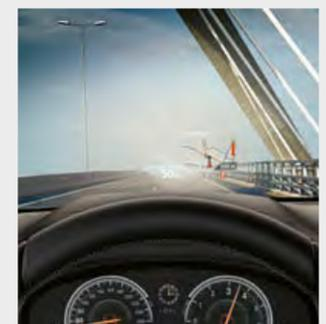
□ El BMW Head-Up Display<sup>2</sup> a todo color proyecta la información relevante para la conducción en el campo visual del conductor.
