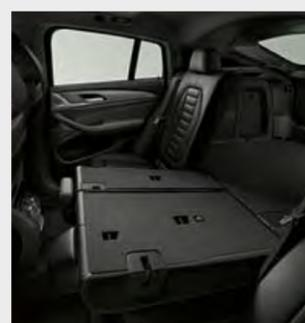
■ El sistema de carga variable con el respaldo de los asientos traseros divisible en la proporción 40:20:40 garantiza una gran flexibilidad para el transporte de personas y objetos.
