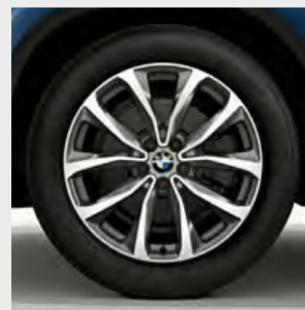
□ Llantas de aleación ligera de 19 pulgadas con radios en V estilo 692, en bicolor Ferricgrey con pulido brillante, 7,5 J x 19, neumáticos 245/50 R 19.
