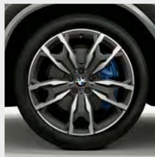
□ Llantas de aleación ligera M de 20 pulgadas con radios dobles estilo 787 M, en bicolor Orbitgrau con pulido brillante, neumáticos de distintas medidas, delante 8 J x 20, neumáticos 245/45 R 20, detrás 9,5 J x 20, neumáticos 275/40 R 20.<sup>3</sup>
