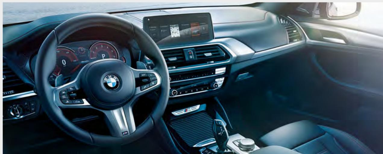
La **ventilación activa de los asientos**<sup>1,2</sup> delanteros proporciona una temperatura fresca y agradable con temperaturas exteriores elevadas y, con ello, una mayor comodidad. Unos ventiladores montados en el asiento y el respaldo emiten aire en tres intensidades a través de la tapicería perforada.
