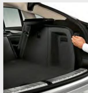
□ El desbloqueo del respaldo<sup>2</sup> de los asientos traseros permite abatir este con comodidad mediante una palanca situada en el maletero.
