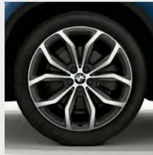
□ Llantas de aleación ligera de 20 pulgadas con radios en Y estilo 695, en Orbitgrau con pulido brillante, neumáticos de distintas medidas, delante 8 J x 20, neumáticos 245/45 R 20, detrás 9,5 J x 20, neumáticos 275/40 R 20.<sup>8</sup>
