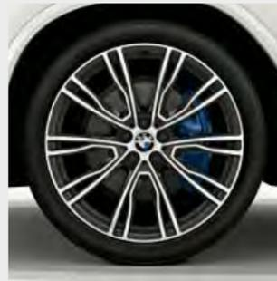
□ Llantas de aleación ligera BMW Individual de 21 pulgadas con radios en V estilo 726 I, en bicolor Orbitgrau con pulido brillante, neumáticos de distintas medidas y funcionamiento en caso de avería, delante 8,5 J x 21, neumáticos 245/40 R 21, detrás 9,5 J x 21, neumáticos 275/35 R 21.
