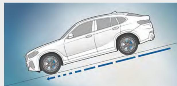
■ El equipamiento **Hill Descent Control** de los modelos BMW xDrive es un control de descensos que se encarga, al activarse, de que el vehículo baje automáticamente y con seguridad por pendientes pronunciadas a una velocidad apenas superior a la de una persona a pie, sin necesidad de pisar el freno.
