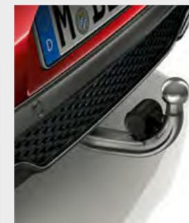
□ El enganche de remolque con bola giratoria eléctrica y control de estabilidad admite cargas de hasta 2.400 kg.
