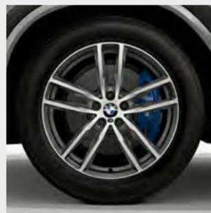
■ Llantas de aleación ligera M de 19 pulgadas con radios dobles estilo 698 M, en bicolor Ferrigrey con pulido brillante<sup>7</sup>, 7,5 J x 19, neumáticos 245/50 R 19.<sup>5</sup>
