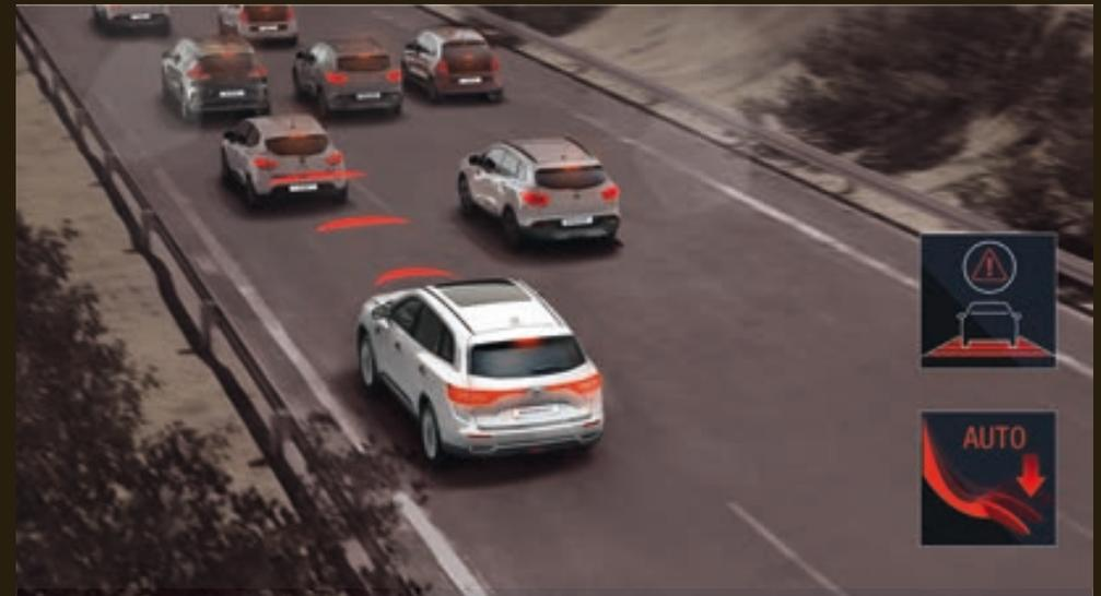
**Frenada activa de emergencia asistida.** En caso de frenada urgente, el sistema actúa como complemento del ABS / ESC para reducir la distancia de frenado.
