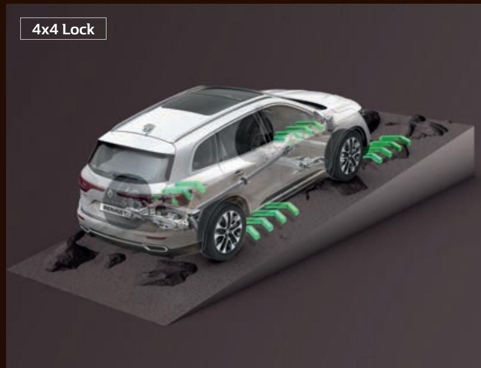
Selecciona Auto para pasar automáticamente a modo 4x4 cuando la situación lo requiere, y consigue una distribución automática de par entre las ruedas delanteras y traseras. Elige el modo Lock para fijar el reparto de par entre el tren delantero y trasero y mantener una transmisión permanente a las cuatro ruedas con el fin de maximizar la adherencia y la estabilidad en cualquier situación. ¡Pasa a la acción y ve más allá con el All Mode 4x4-i de Nuevo Koleos!
